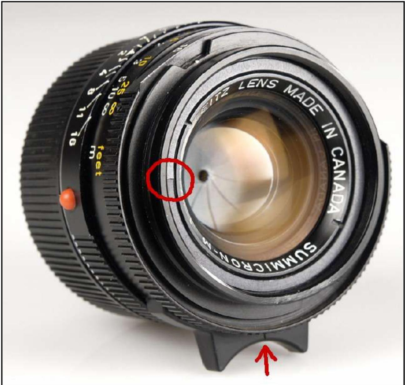
(foto 2) **PRIMA VERSIONE.** Nell'immagine si nota una lesione del supporto sintetico dove è avvitata la ghiera di fermo (in alluminio) della lente frontale.
